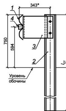
Схема сборки дорожных ограждений 21 ДО по ГОСТ 26804-2012
